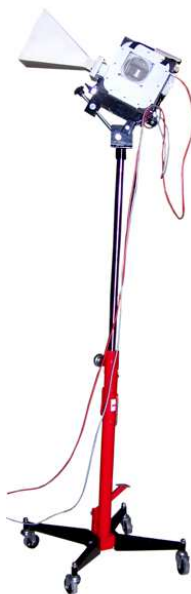
Rysunek 10: Urządzenie mikrofalowe zamontowane na podnośniku hydraulicznym
